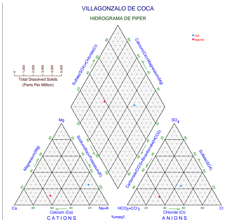
Figura 6. Hidrograma de Piper-Hill-Langelier con representación del agua de recarga artificial y la medida en el cuenco de la laguna de la Iglesia de Villagonzalo de Coca en febrero de 2006.
