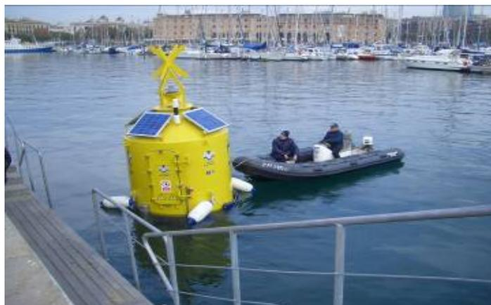
La toma de muestras se realiza a cuatro profundidades diferentes, desde la superficie, hasta los tres metros, en intervalos de 1 m, de manera que todas las medidas de calidad ofrecen los cuatro valores correspondientes a las cotas de toma.
