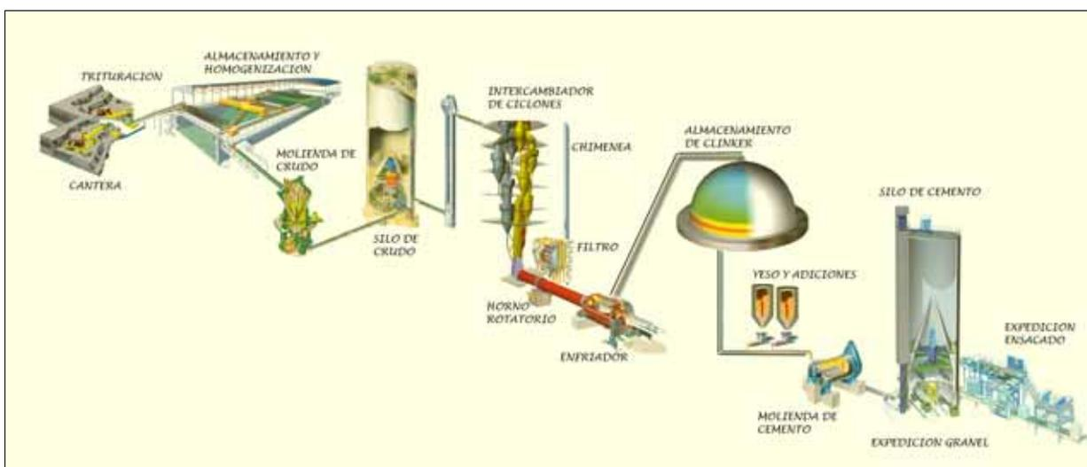
*Esquema del proceso de producción de cemento*
