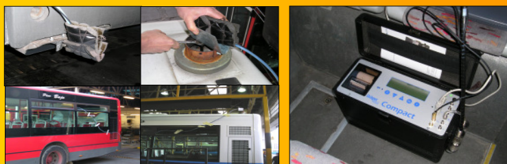
Figura 6. Detalles colocación sonda en los vehículos con motor diesel o Gas Natural Comprimido
