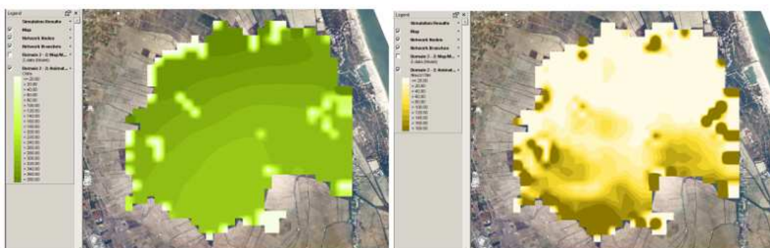
Figura 2. Ejemplo de simulación en calidad de aguas 2D. Concentración simulada de clorofila-a ( \mu\text{g/l} ) en el lago de la Albufera a las 12:00 el 17 de octubre de 1995 (dcha.) Flujo de resuspensión ( \text{g/m}^2.\text{día} ) el 29 de diciembre de 1996 (izq.)
