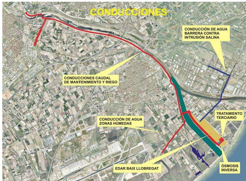
*El agua regenerada tendrá como principales usos la aportación al caudal ecológico del río Llobregat, la sustitución de parte del agua que se deriva desde el río al canal de la margen derecha del río Llobregat por agua regenerada, el riego de las zonas húmedas construidas en la desembocadura del nuevo cauce del río y la creación de una barrera hidráulica contra la intrusión salina para que proteja el acuífero del delta.*
