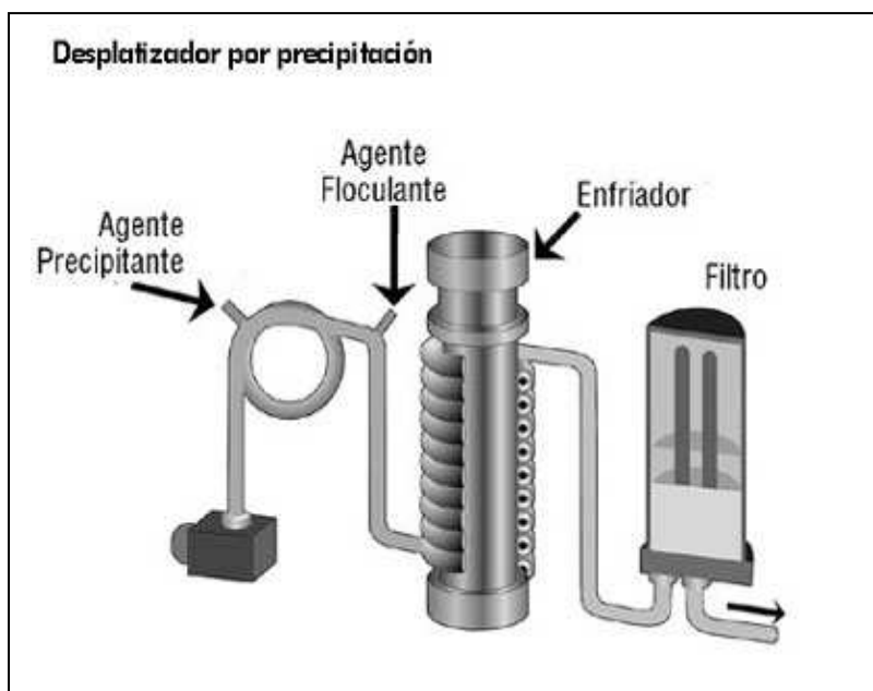
Fig: Esquema del proceso de un sistema de recuperación de plata por Precipitación
