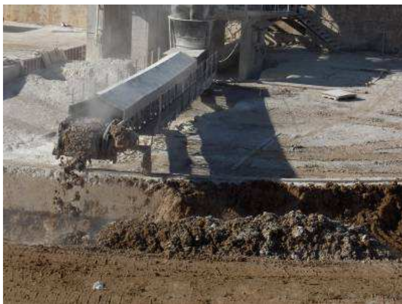
Foto 23: Vertido de la mezcla en el foso para su fraguado y posterior extracción
