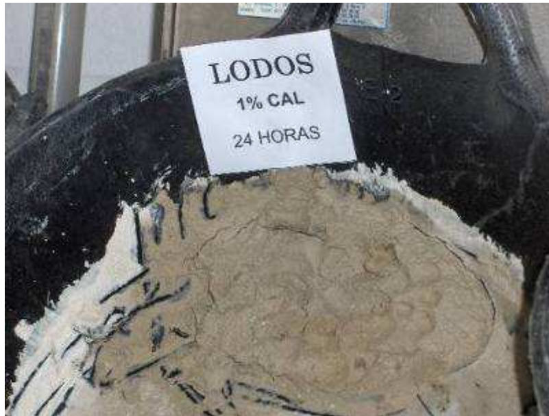
Foto 2: Muestra de la mezcla al 1 % a las 24 horas.
