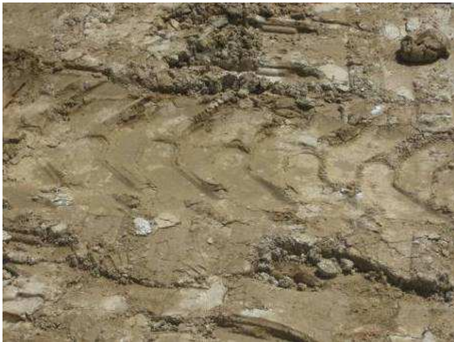
Foto 17: Huella de la mixta a las 5 horas.
