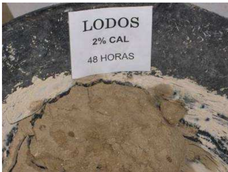
Foto 3: Muestra de la mezcla al 2 % a las 48 horas.
