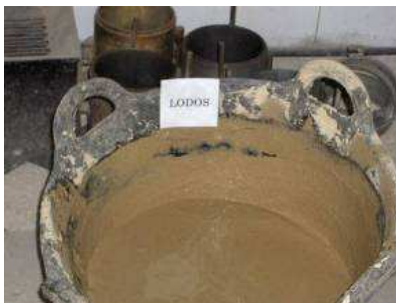
Foto 1: Muestra de lodos recogida para ensayos de laboratorio
