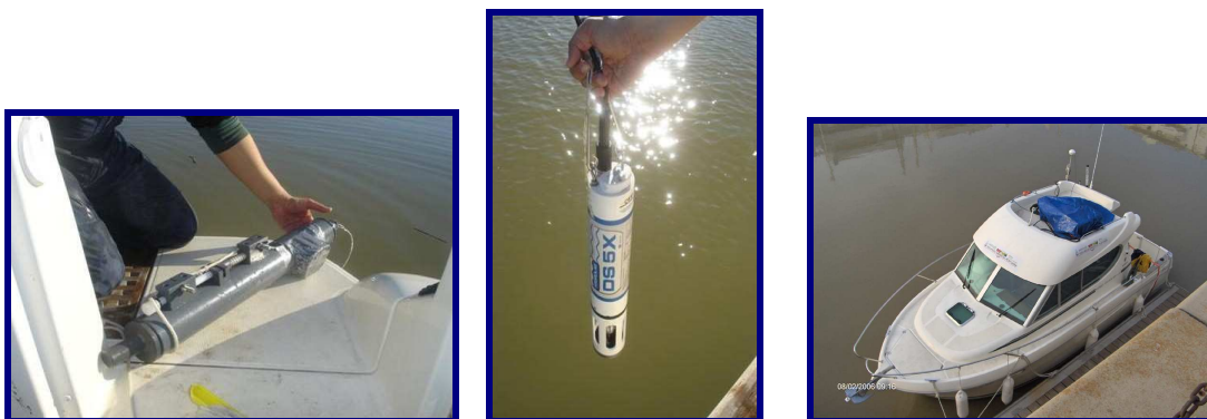
Figuras 9, 10 y 11. Botella hidrográfica Niskin , sonda multiparámetro y embarcación (“Doñana”) con la que se realizan los muestreos
